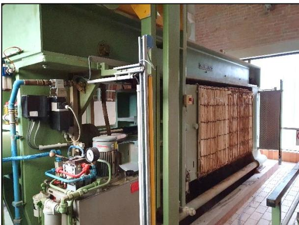
Abb. 31 Kammerfilterpresse
